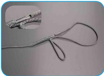
Introduisez l'extrémité dans l'aiguille creuse et faire une pénétration sur 100 fois le diamètre.
