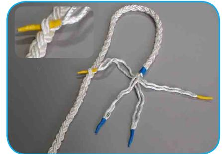
Passez l'un des torons Z sous un toron S. Les torons S circulent de gauche à droite, inversement pour les Z.
