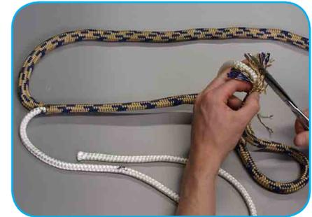
Détressez et réalisez un dégradé sur l'extrémité de la gaine.
