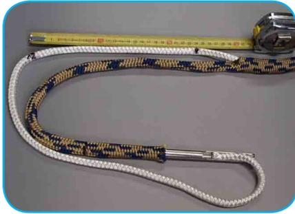
A l'aide d'une aiguille creuse introduire l'âme dans la gaine.
