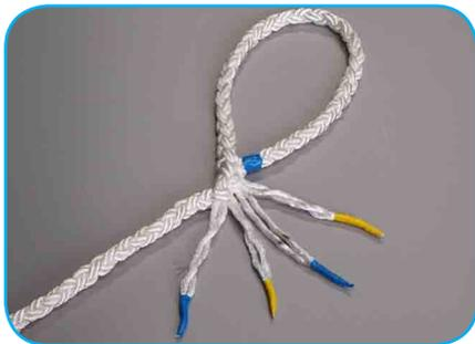
Passez les torons S sous les torons Z en suivant le tressage. Vous avez réalisé la deuxième passe.
