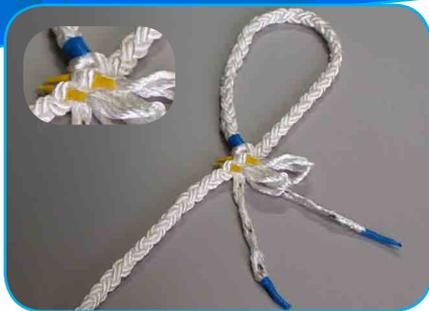
Passez les torons Z sous les torons S en suivant le tressage.
