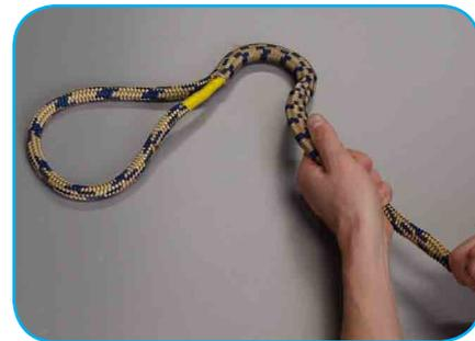
A partir du nœud retroussez la gaine vers la boucle, l'âme doit totalement disparaître.
