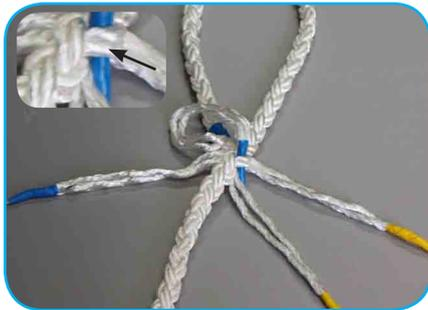
Passez l'un des torons S sous un toron Z.
