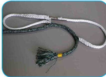
Au deuxième point de marquage introduisez l'extrémité de l'âme à l'aide de l'aiguille creuse.
