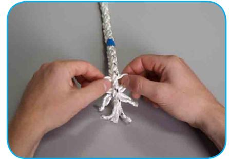
Détressez le cordage jusqu'au scotch en séparant les torons S et les torons Z.
