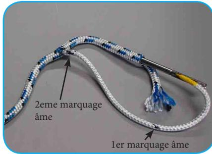
A l'aide d'une aiguille creuse introduire l'âme dans la gaine au 1er point de marquage de gaine.
