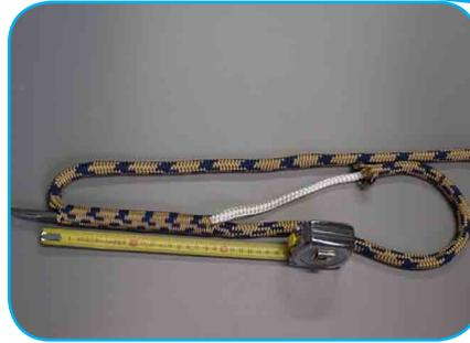
Ressortez l'aiguille creuse 20cm après l'intersection de boucle.
