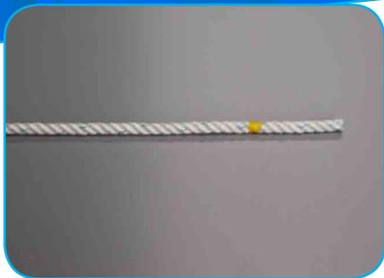
Placez un scotch à 10 fois de diamètre du cordage, soit 10cm sur un cordage de 10mm.
