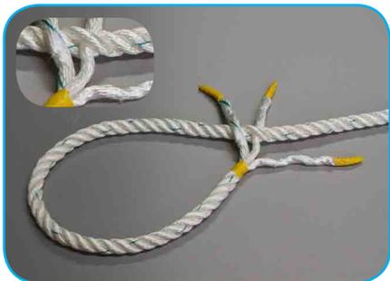
Passez le toron courant du milieu sous un toron dormant.
