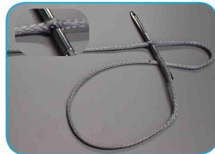
Introduisez l'extrémité dans une aiguille creuse puis traversez la tresse au deuxième point de marquage.
