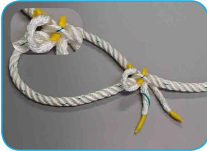
Passez en sens inverse le dernier toron courant sous le dernier toron dormant.
