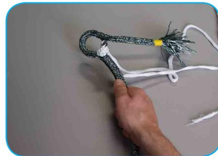
Réitérez l'opération jusqu'à ce que l'âme disparaisse entièrement sous la gaine.
